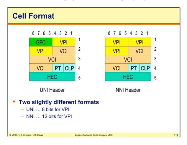
Cell Size 53 byte: 5 byte header and 48 byte payload.
